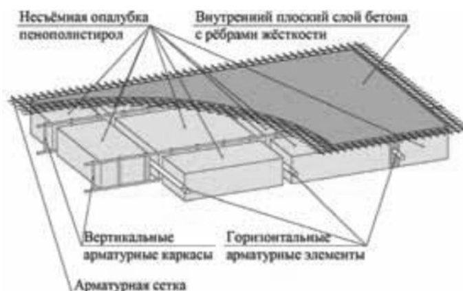
Рисунок 5 – Регулярная зона двухслойной конструктивно-силовой схемы монолитной стены сборного мобильного крупногабаритного модуля
