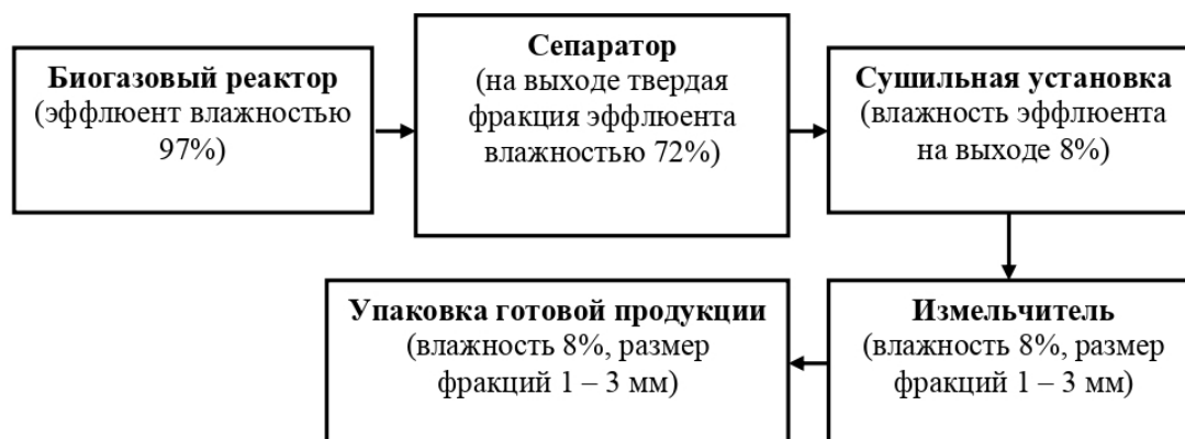
Рисунок 1 – Технологическая схема приготовления кормовой добавки из эффлюента биогазового реактора
