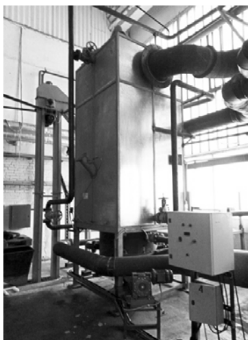
Рисунок 4 – Внешний вид реактора торрефикации с КС
