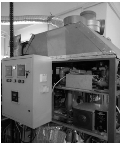
Рисунок 8 – Биогазовая установка с рециркуляцией сброженного осадка и обработкой в аппарате вихревого слоя
