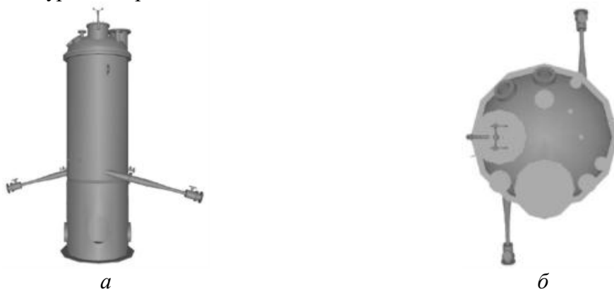
Рисунок 2 – Ферментер колонный: а – вид сбоку; б – вид сверху
